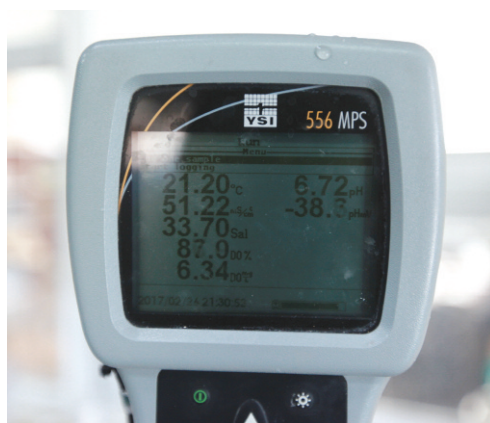
그림 22. 수질측정기 측정(좌)과 수질측정장비 화면(우)
