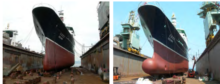
그림 5-7. 구상선수 설치 전후의 원양 선망어선
