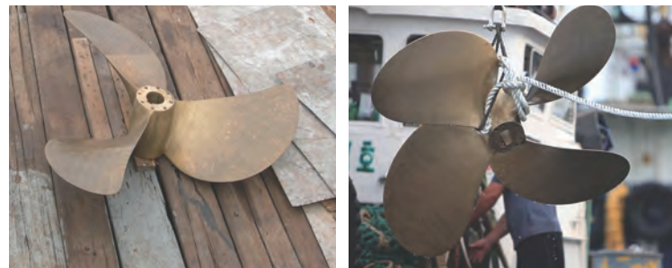
그림 5-8. 기존 프로펠러 추진기(좌) 및 신규설계 추진기(우)
